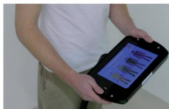
Le tableau de commande électronique pivote sur 180°, ce qui permet également au personnel un maniement simple et confortable.
